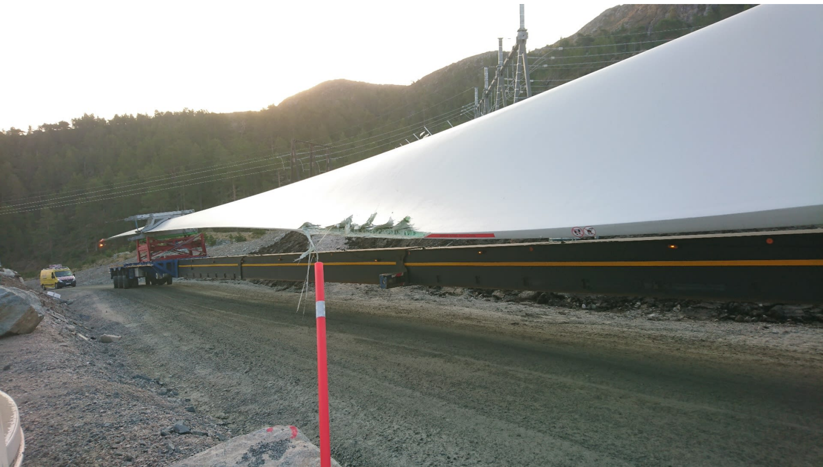
Skade på turbinblad under transport til Hitra 2 vindpark
